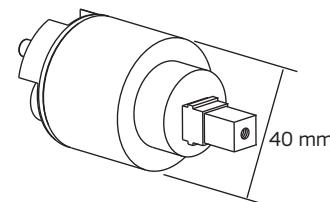
OBS.: O MECANISMO MONOCOMANDO "A" PARA ALTA E BAIXA PRESSÃO, TEM DIÂMETRO DE 40 mm.
