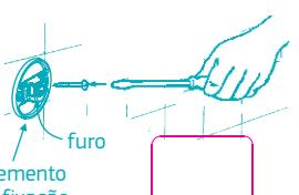
4) Posicione a canopla com o furo virado para baixo e encaixe a papeleira sobre o elemento de fixação, fixe-os apertando o parafuso com o auxílio da chave allen.
