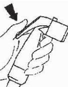
Para interromper o fluxo, aperte a alavanca para liberar o botão, soltando-a em seguida.
