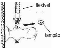
Se o ponto de água não for exclusivo, retire o tampão do registro e fixe a extremidade do flexível (1984 com derivação).
