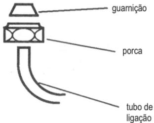
Instale o tubo na duchinha e no central, conforme indicado na figura.
