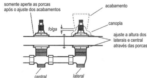
Guarde os acabamentos, instalando-os após a montagem completa do misturador, conforme indicado no folheto.
