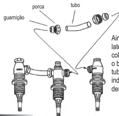
Ainda com os laterais e central colocados sobre o bidê, monte os tubos, conforme indicado no desenho ao lado.
