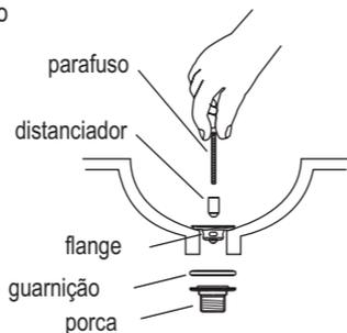
3 Aperte o parafuso utilizando uma chave de fenda adequada.
