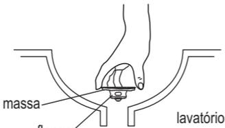
2 Coloque a porca e a guarnição pela parte inferior do lavatório, fixando-a, por cima com o parafuso e com o distanciador montado.
